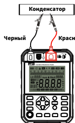
Рис. 9.3.3.1 Проводное подключение измерения емкости
