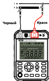
Рис. 9.3.2.1 Проводное подключение измерения напряжения
